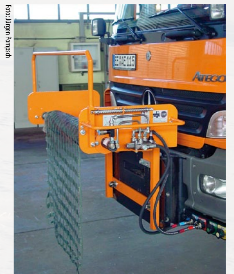
UNIVERSELLE WICKELMASCHINEN für Schneezäune erleichtern den Auf- und Abbau erheblich.
